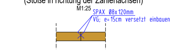
Regeldetail Deckenstoß d=12cm (Stöße in richtung der Zahlenachsen)
